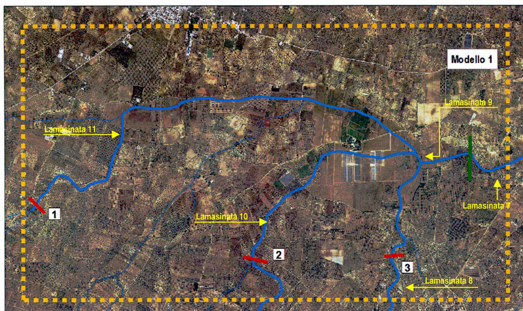
Figura 5.10 – Rappresentazione del dominio di calcolo (tratteggio arancione) con indicazione delle condizioni di input (in rosso) e output (in verde)
